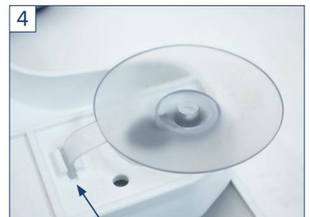
4. Die vorderen Sauger in gleicher Weise einsetzen, hier jedoch zusätzlich die Entlüftungslaschen in die Aussparungen der Bodenplatte seitlich einführen. Dadurch werden die vorderen Sauger beim Herausnehmen automatisch belüftet.
