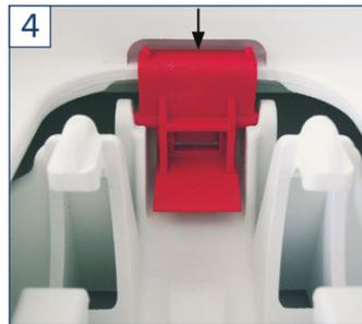
4. Durch den Transport kann sich der rote Arretierhebel aus den Aufnahmebohrungen lösen. Durch Drücken von oben kann er leicht wieder eingerastet werden. Bitte prüfen Sie den festen Sitz des Arretierhebels.
