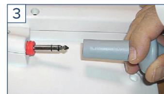
3. Die Handbedienung am Rückenteil hinten einstecken. Hierzu die Buchse am Spiralkabel auf den Stecker schieben, bis die Verriegelung spürbar einrastet und der rote Ring am Klinkenstecker nicht mehr sichtbar ist.
