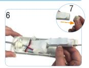
Entnehmen Sie den Akku (Abb. 6) und entfernen Sie das Polster an der Stirnseite (Abb. 7). Befestigen Sie das Polster am neuen Akku.
