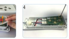
Öffnen Sie die zwei Befestigungsschrauben der Platine.
